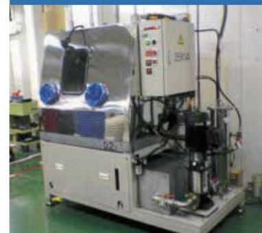
上下スプレーノズルからの洗浄剤噴射で、金型に付着した汚れを洗い落とし面倒な金型メンテナンス時間を大幅短縮。大型グローブボックス、大型ガラスの採用で死角に残った汚れも作業者が確認しながら除去できます。
