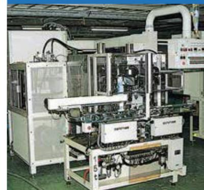
自動吸水、洗浄剤自動供給、洗浄液濃度コントローラーを組み込むシステム設計。自社製の高性能高圧プランジャーポンプを搭載。ワーク搬入から搬出までの全自動システムが可能です。
